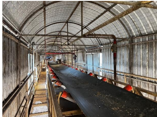
รูปที่ 9 ฝารอบและหัวฉีดน้ำ บริเวณสายพานลำเลียงขนอ้อย
