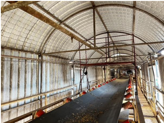
รูปที่ 9 ฝารอบและหัวฉีดน้ำ บริเวณสายพานลำเลียงขนอ้อย
